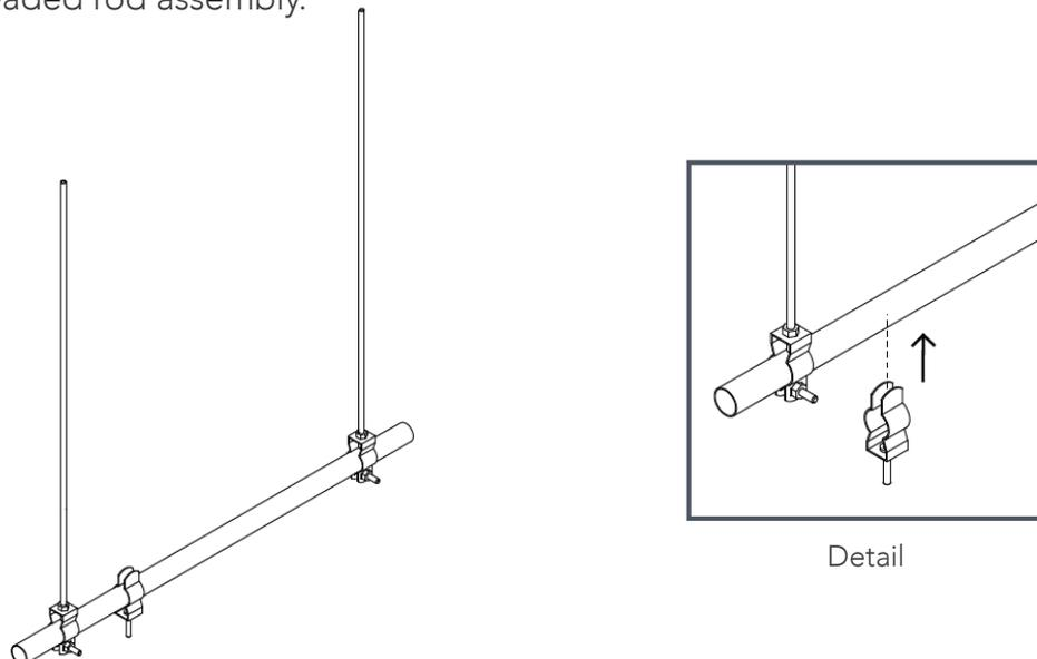
3. Insert the coupling nut to the conduit clip bolt.
